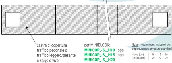
**SEZIONE LONGITUDINALE - Elem. Modulare**
